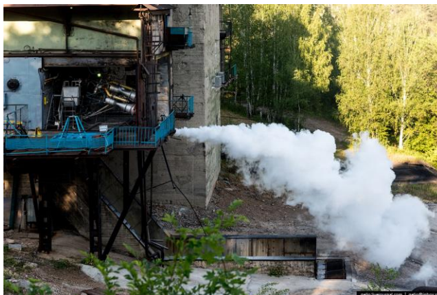
Рис. 5 За несколько минут до начала огневых испытаний. Захлаживание систем (жидкий азот -195,75°C )
